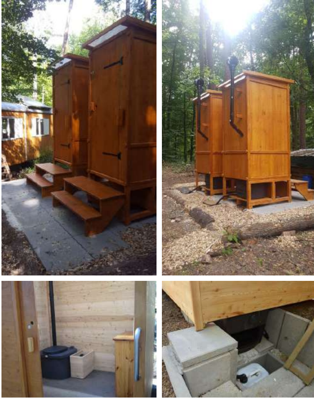
oben: Modell WIESE mit Biolan eco. Kabine ist auf einem Podest erhöht. unten: Modell WALD-barrierefrei. Die Biolan ist vertieft. Eine Wartungsschacht ermöglicht die Leerung der Biolan.
