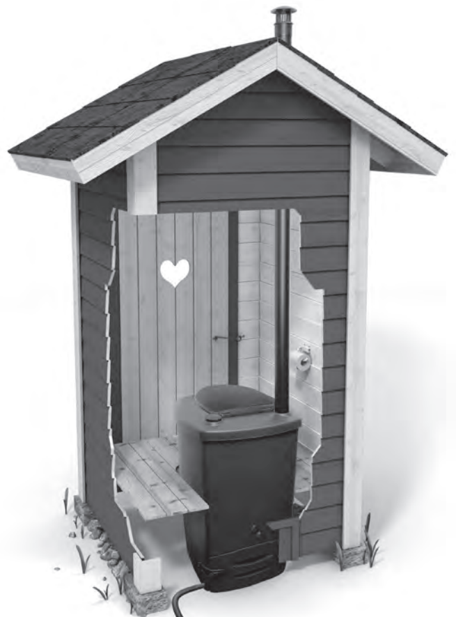
Skizze für die Toiletteninstallation und Aufstellung des Flüssigkeitskanisters
